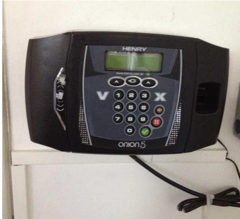
Figura 4-6 Equipamento que controla o acesso à sala de *freezers*.
