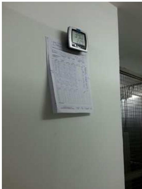
Figura 4-3 Termômetro para verificação de temperatura ambiente e documento para registro.
