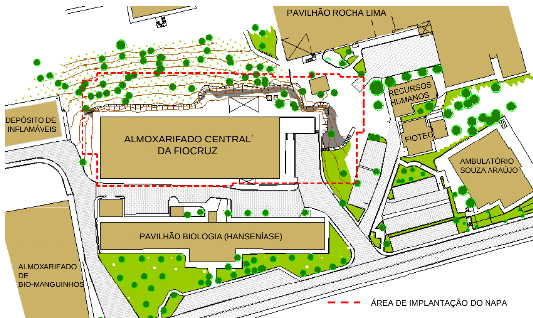
Figura 4.4 – Recorte do relevo topográfico e área de implantação do Novo Almoxarifado e Prédio Administrativo. Fonte: Projeto básico para construção do NAPA.
