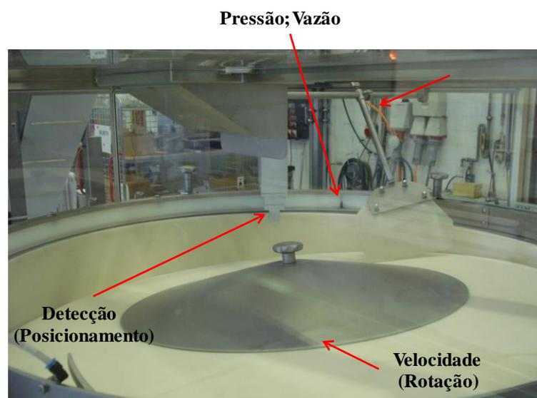
**Figura 4.2** – Identificação dos parâmetros de acordo com posicionamento do componente da estação de posicionamento.
