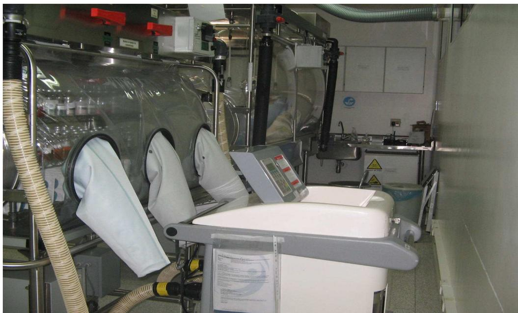
Figura 1.2 Módulo de transferência do sistema isolador conectado ao gerador de gás esterilizante e ao fundo o módulo de trabalho do Instituto de Tecnologia em Imunobiológicos/ Bio-Manguinhos/FIOCRUZ (foto capturada por Madalena de Jesus Vieira).
