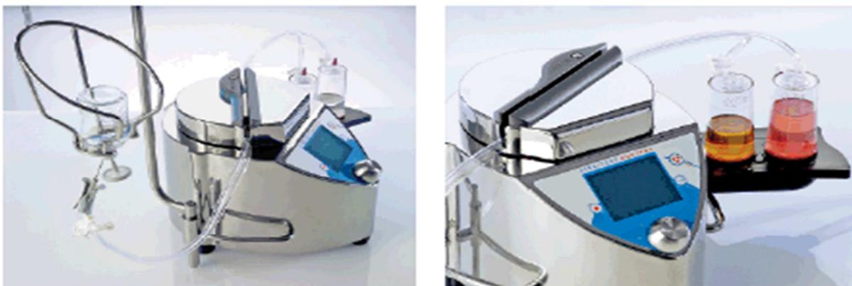
Figura 1.4 Bomba de vácuo denominada de Steritest (Millipore 2010).
