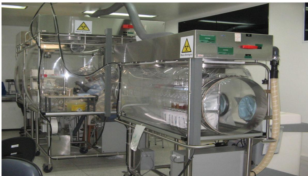
Figura 1.1 Sistema isolador com módulo de transferência conectado ao módulo de trabalho do Instituto de Tecnologia em Imunobiológico/Bio-Manguinhos/FIOCRUZ (foto capturada por Madalena de Jesus Vieira).
